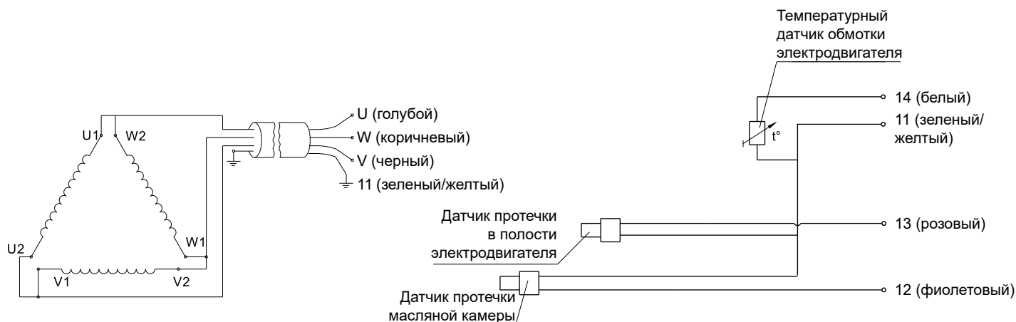
Схема подключения погружных канализационных насосов WQ/ES (треугольник)
