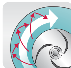
Стандартное рабочее колесо не предполагает однородность потока.
